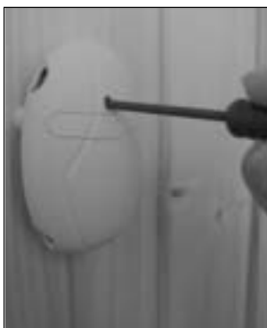
Figure 35. Reset button for overheating limiter Abbildung 35. Rücksetzknopf des Überhitzungsschutzes
